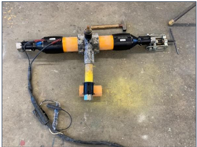
Abbildung 7: Vorbereitung der Prüflinge für H2 Prüfungen
