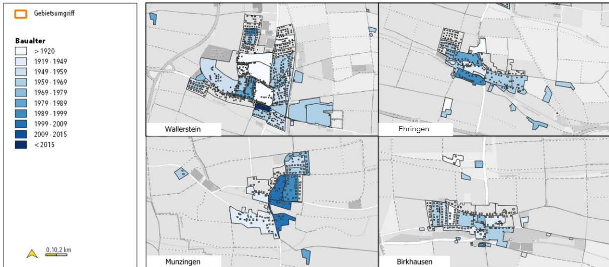
Abbildung 7: Verteilung der Baualterklassen nach Baublöcken in Wallerstein (Quelle: eigene Darstellung)
