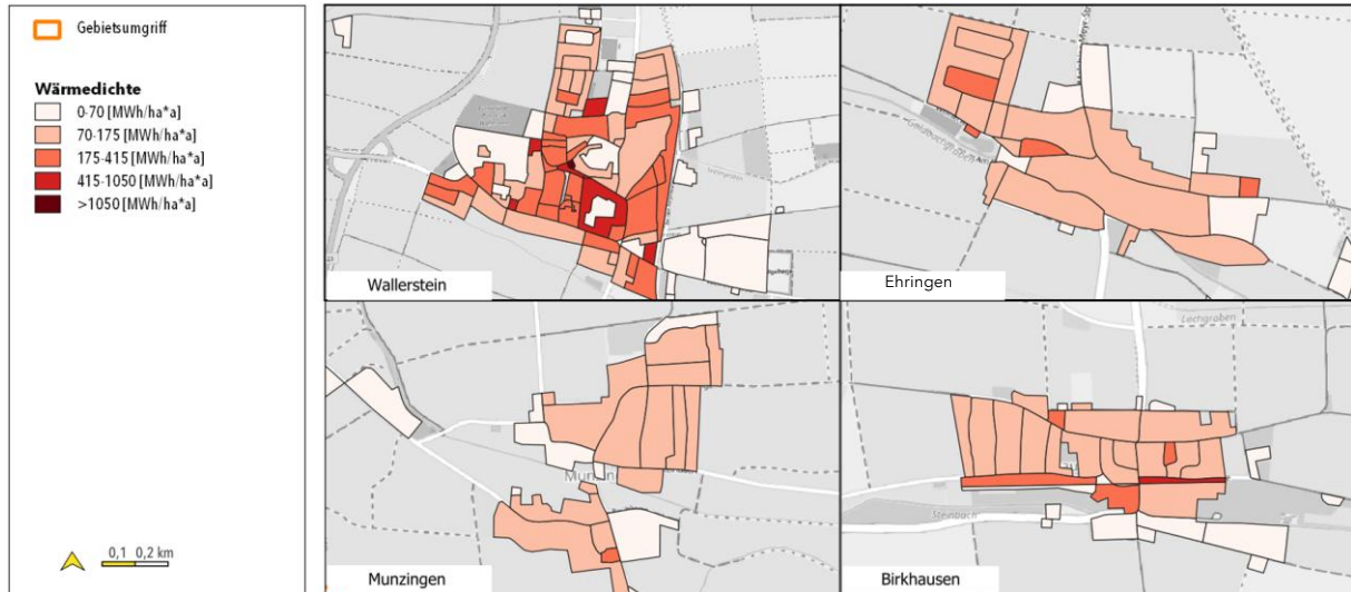
Abbildung 19: Projizierte Wärmedichte 2045 basierend auf einer jährlichen Sanierungsrate von 1 % (Quelle: eigene Darstellung)
