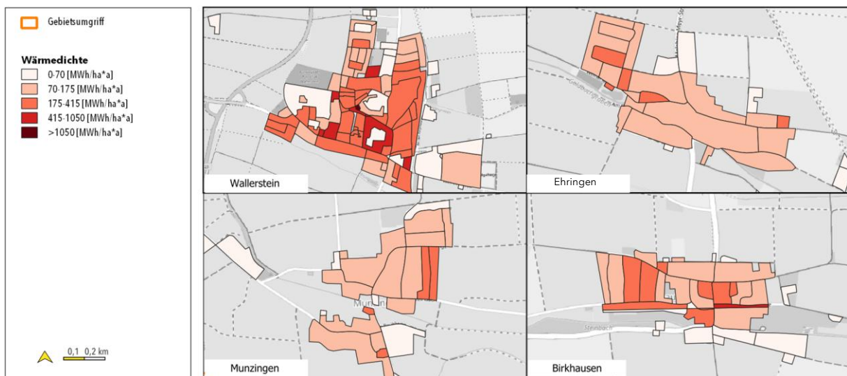
Abbildung 17: Geclusterter Wärmebedarf in Wallerstein (Quelle: eigene Darstellung)
