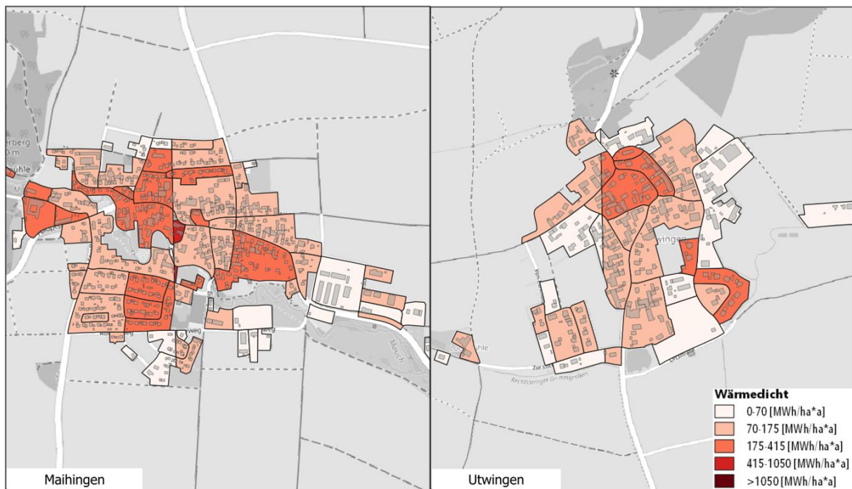
Abbildung 16: Geclusterter Wärmebedarf in Maihingen (Quelle: eigene Darstellung)
